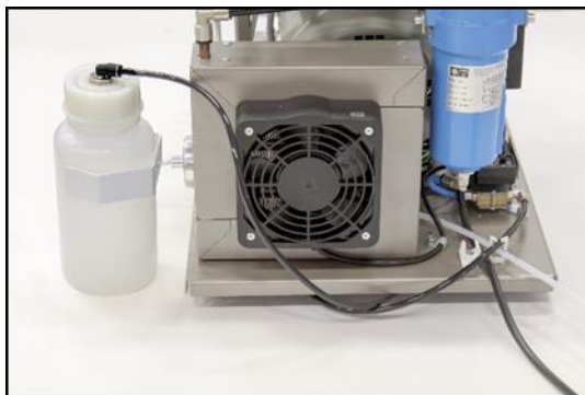
Abb. 7: Anschluss des Kondensatauffangbehälter
