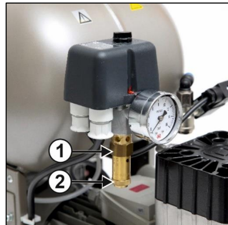
Obr. 13: Kontrola poistného ventilu
