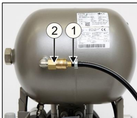
Obr. 6: Pripojenie k výstupu stlačeného vzduchu
