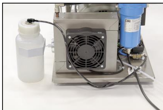
Obr. 7: Pripojenie nádoby na zber kondenzátu
